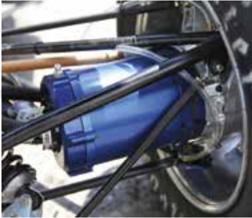
Un motor eléctrico independiente fabricado con iCARE® Save impulsa cada rueda
