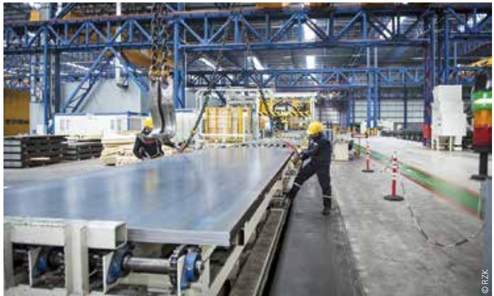
La empresa puede transformar chapas con espesores de hasta 1000 mm y anchos de hasta 4000 mm, ideal para responder a las necesidades de las empresas navales y de petróleo y gas de la zona.
